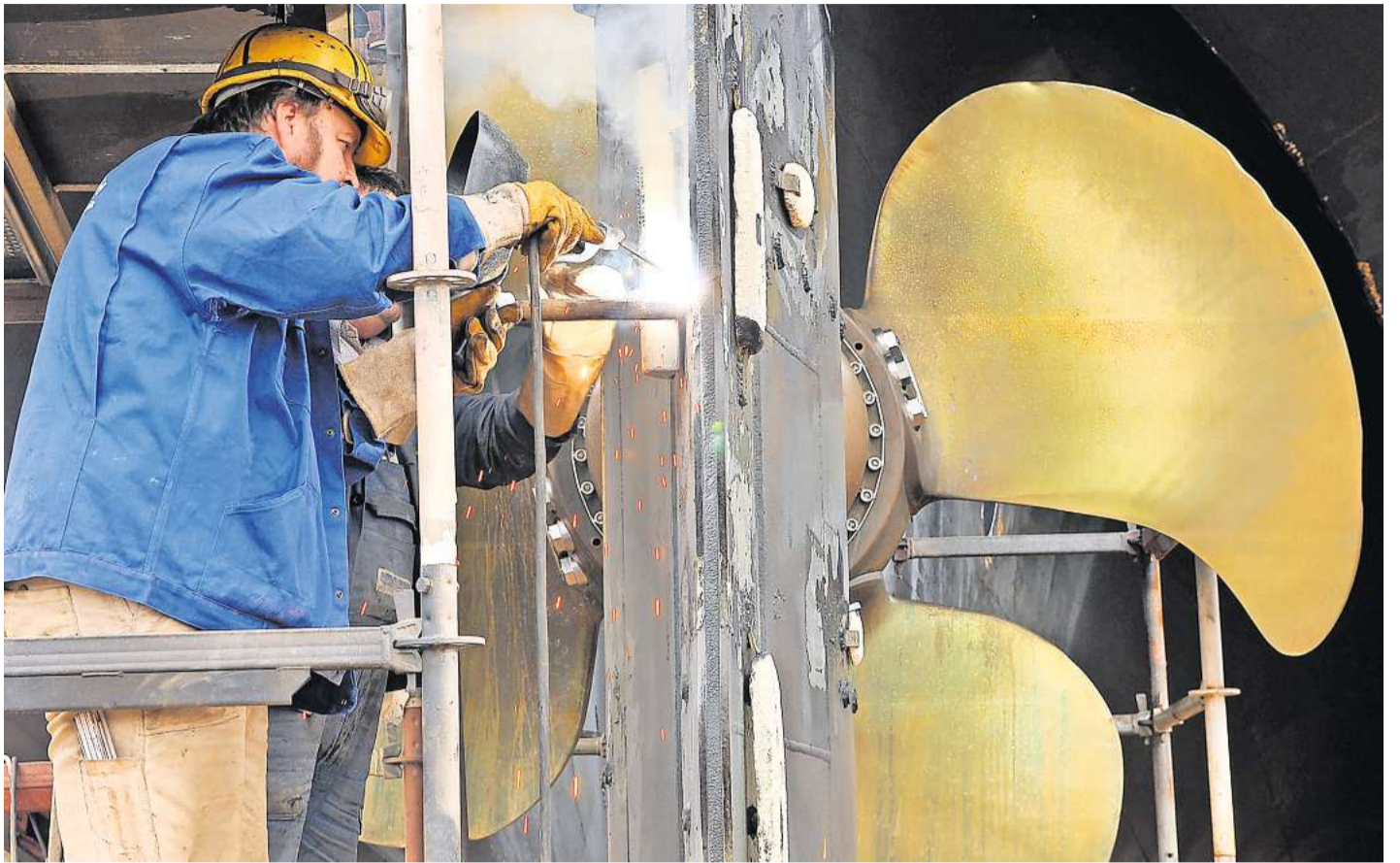
An einem Ruderblatt werden von einem Schiffbauer in Kiel Opferanoden angeschweißt. Die Pandemie hat besonders an der Ostsee zu Personalabbau bei Werften geführt.
